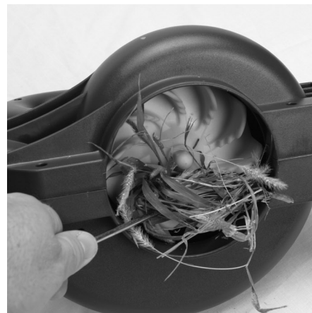
Figura 4-13. Retiro desechos de los impulsores
